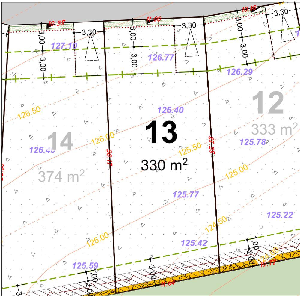
Emplacement projeté de l'enveloppe béton recevant les alimentations. Les attentes eau potable et télécom seront dans un regard. L'acquéreur et le constructeur devront tenir compte de l'emplacement de ces ouvrages, lors de l'établissement du projet ainsi qu'à la réalisation de la construction. Pour des raisons techniques, l'aménageur se réserve la possibilité de modifier la position de ces coffrets.
