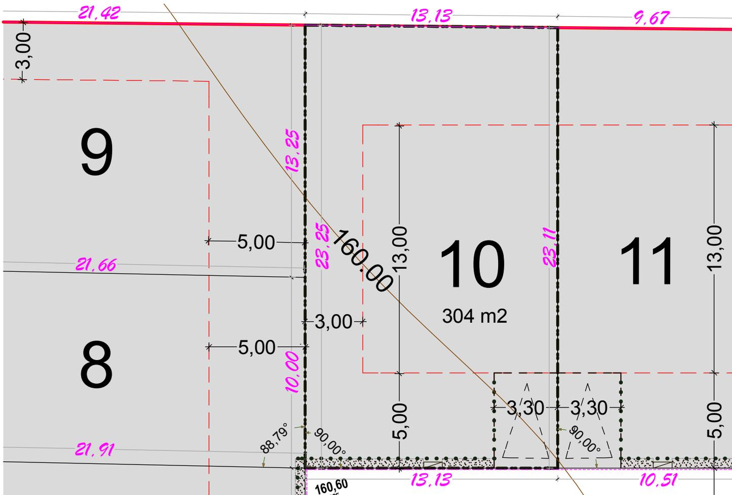
Emplacement projeté de l'enveloppe béton recevant les alimentations. Les attentes eau potable et télécom seront dans un regard. L'acquéreur et le constructeur devront tenir compte de l'emplacement de ces ouvrages, lors de l'établissement du projet ainsi que lors de la réalisation de la construction. Pour des raisons techniques, l'aménageur se réserve la possibilité de modifier la position de ces coffrets.
