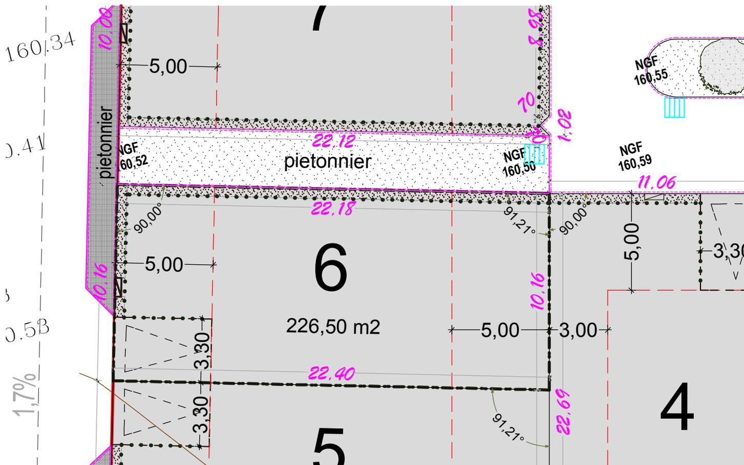
Emplacement projeté de l'enveloppe béton recevant les alimentations. Les attentes eau potable et télécom seront dans un regard. L'acquéreur et le constructeur devront tenir compte de l'emplacement de ces ouvrages, lors de l'établissement du projet ainsi que lors de la réalisation de la construction. Pour des raisons techniques, l'aménageur se réserve la possibilité de modifier la position de ces coffres.
